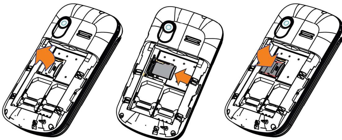
Para soltar o suporte de cartão MicroSD, deslize-o na direção da seta e suspenda-o. Em seguida, insira o cartão microSD com o contato dourado virado para baixo e deslize-o na direção oposta para trava-lo.
