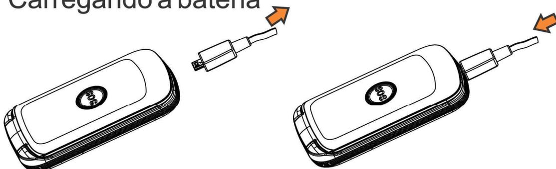
Conecte o carregador da bateria ao seu celular e na tomada de energia respectivamente.
