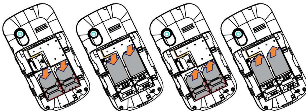
Coloque o cartão SIM com os conectores virados para baixo e deslize-o na ranhura. Certifique-se de que ele foi inserido corretamente. Para remover o cartão, pressione e deslize-o para fora.
