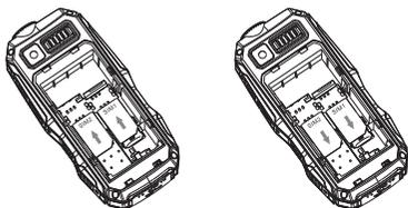
Coloque o cartão SIM com os conectores metálicos virados para baixo e deslize-o na ranhura. Certifique-se de que ele foi inserido corretamente. Para remover o cartão SIM, pressione e deslize-o para fora.
