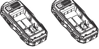
Para soltar o suporte de cartão Micro SD (não incluso), deslize-o na direção da seta e suspenda-o. Em seguida, insira o cartão Micro SD (não incluso) com o contato dourado virado para baixo. Após, deslize o suporte na direção oposta para travá-lo.
